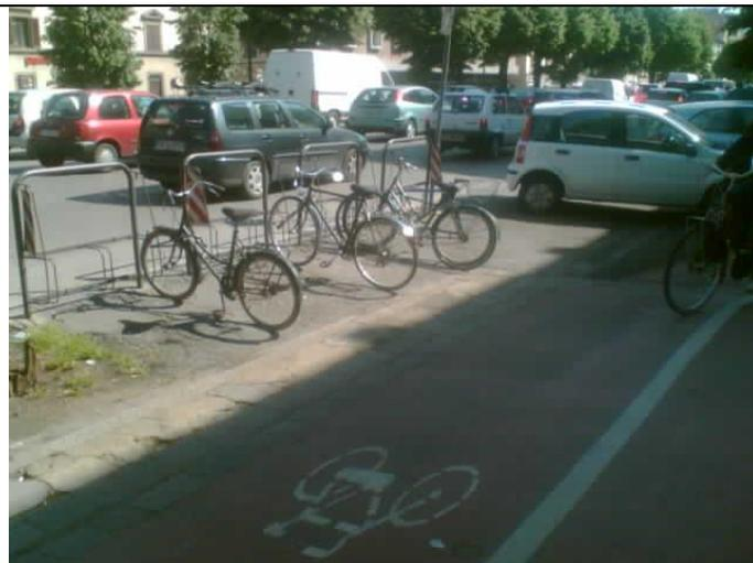
Rastrelliera ad invito della ruota anteriore su parapetonale. Risulta non adeguata perché non permette di assicurare il telaio alla rastrelliera e favorisce il furto con l'asporto di tutta la bici o con l'abbandono della ruota anteriore. Se la rastrelliera è in pendenza, l'uso è scomodo.
